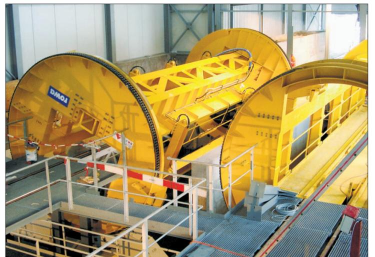
Die Firma Reber montierte in Sedrun diese Rotationskippe. [Bild vZg Rowa]
