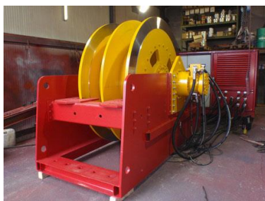
Seilwinde HY150/500 Einsatz: Stollenbau
